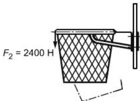
Рисунок Ж.2 - Схема приложения нагрузки к жестко закрепленному кольцу
